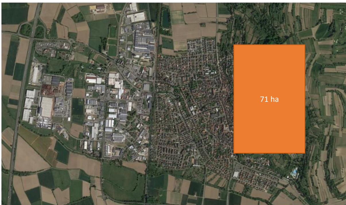
Abbildung 43: Benötigte Fläche für Erdsonden für eine vollständige Wärmeversorgung (bilanziell) von Herbolzheim (Bildquelle: Google Earth)
