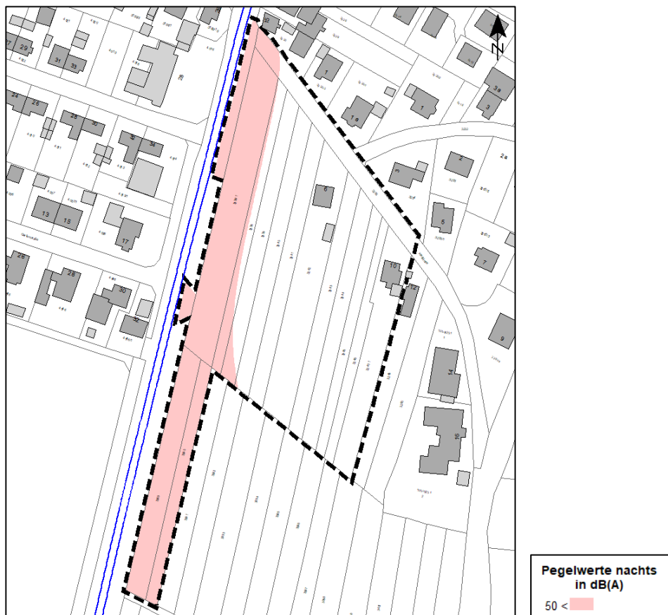
Abbildung – Kennzeichnung Lüftungseinrichtungen (hellrot: Pegelwerte nachts > 50 dB(A)), Rechenhöhe 6 m über Gelände
