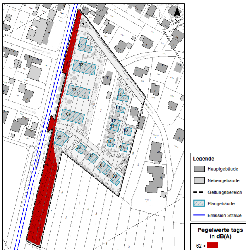
Abbildung 6 – Kennzeichnung Schutz der Außenwohnbereiche mit Plangebäude (dunkelrot: Pegelwerte tags > 62 dB(A)), Rechenhöhe 6 m über Gelände 3
