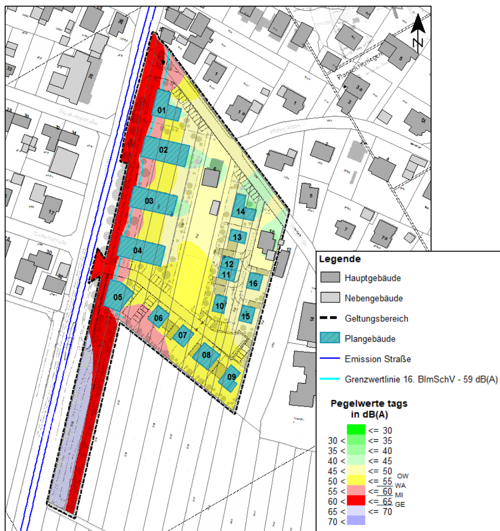
Abbildung 3 – Rasterlärmkarte Straßenverkehr mit Plangebäuden, tags, Rechenhöhe 6 m über Gelände (ca. 1.OG)
