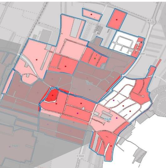
Abbildung: Wärmedichten auf Baublockebene im Teilgebiet
